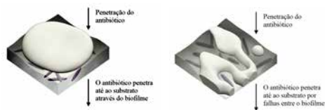
Figura 2 – Penetração do anti-microbiano antes e depois da acção de surfactantes e biocidas
